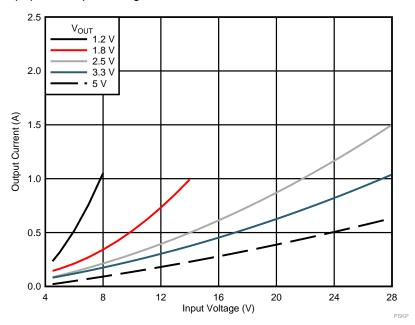
Figure 25. Pulse-Skipping Threshold
